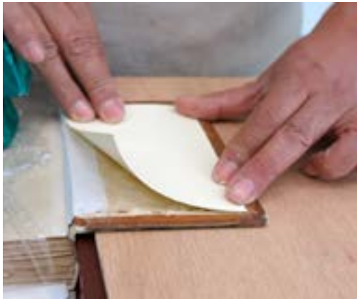
Foto 29. Colocación de compensador
